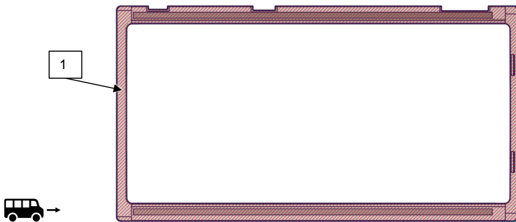
Abb. 2-5: Verklebebereich des GFK-Rahmens / Gluing area GRP frame [A0004005]
