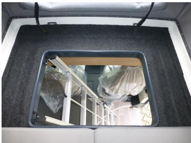
Abb. 8-1: Verkleidung des Dachdurchstieg / Cladding of the roof access
