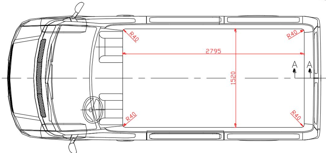
An den Ecken jeweils eine Bohrung 10 mm setzen, zum Eintauchen der Stichsäge.
