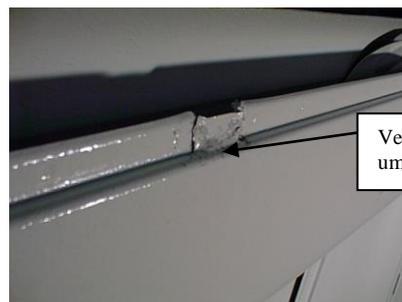
Die Verprägungen am Karosserierand innenseitig, einschneiden und nach außen umlegen oder zurückstellen. Schnittkanten mit Deckenschutzfarbe behandeln.
