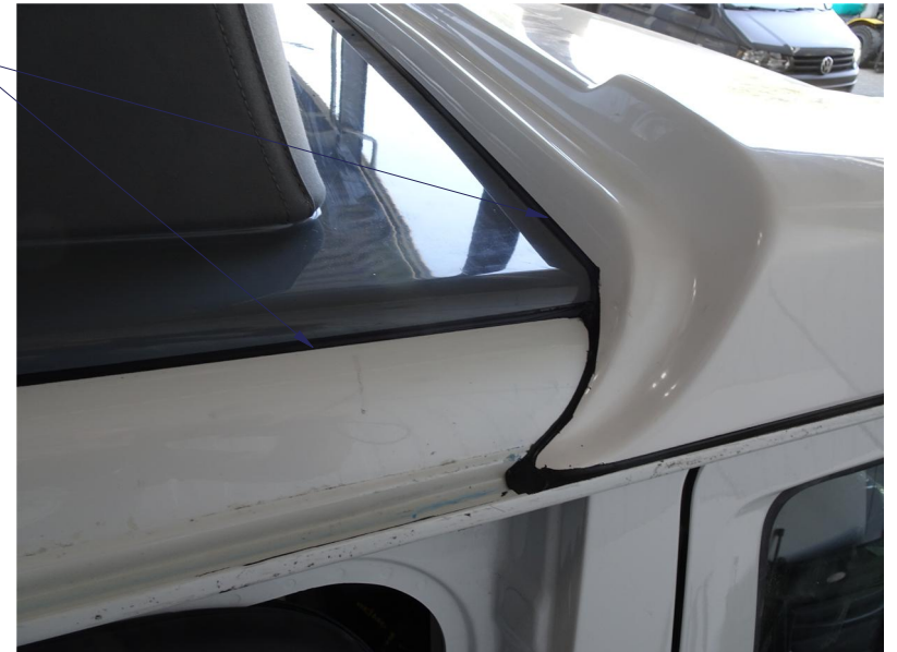
Spoiler und GfK-Rahme von außen mit SIKA abgedichtet
