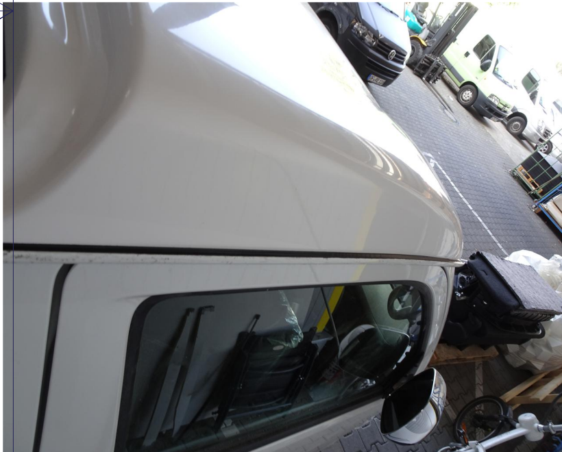
Spoiler und GfK-Rahme von außen mit SIKA abgedichtet
