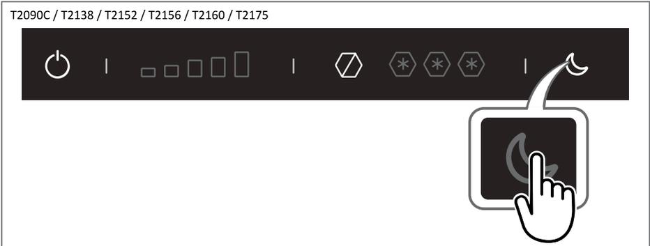
Verwenden Sie den Nachtbetrieb nur, wenn die Temperaturen im Fahrzeug unter 30 °C liegen. Der Nachtbetrieb schaltet sich nach 12 Stunden automatisch aus. Wenn der Nachtbetrieb per Hand ausgeschaltet wird, erfolgt ein Wechsel in die automatische Temperaturregelung.
