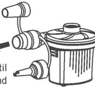
Das Ventil des zu befüllenden Produkts darf nicht blockiert oder verstopft sein, ansonsten kann zu Überhitzung und Schäden an der Pumpe kommen. Nutzen Sie niemals die Saugfunktion, während ein Produkt befüllt wird.
