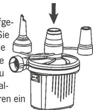
Das Ventil des zu entleerenden Produkts darf nicht blockiert oder verstopft sein, ansonsten kann zu Überhitzung und Schäden an der Pumpe kommen.
