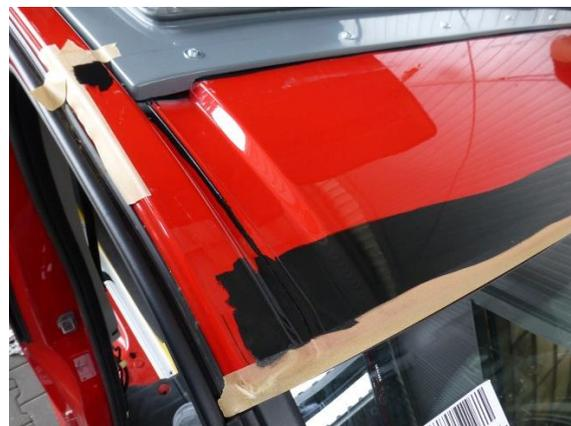
28. Karosseriefläche zwischen Dachrahmen + Frontscheibe reinigen, Kante über Frontscheibe mit Krepp ca 5mm abkleben
