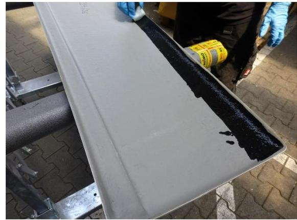
29. Randbereiche der Spoilerunterseite ca. 8 cm breit reinigen, ablüften lassen. Danach Primer auftragen, ablüften lassen
