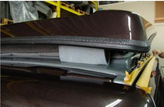
22. Dachschale vorsichtig leicht öffnen und für Verschraubung mit Klötzen unterbauen
