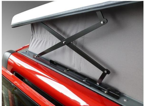
24. Dachschere in vorgesehenen Schraubpunkten mit 3 M6-Schrauben festschrauben (hier auch Justage der Dachschale)
