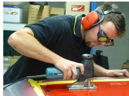
2. Dachausschnitt gemäß beiliegender Zeichnung anzeichnen, Ecken bohren und Dachhaut ausschneiden
