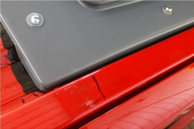
23. Verschrauben des GFK-Dachrahmens: Schrauben zunächst lose einschrauben. Wenn alle Schrauben sitzen, gleichmäßig anziehen. Achtung: Zu starkes Festziehen kann Verzug bewirken
