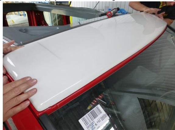
30. Sika in ca.5cm großen Klecksen in Spoilerecken und entlang der Vorderkante auftragen, Spoiler mittig aufsetzen und entsprechend den Markierungen ausrichten
