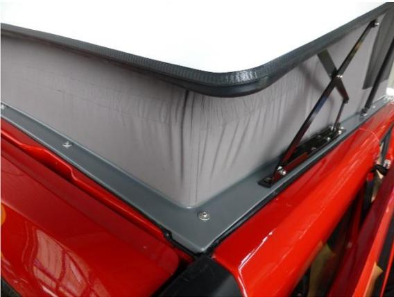
25. GFK-Dachrahmen umlaufend mit Sikanaht abdichten. Dazu Nahtbreite vorher mit Kreppklebeband sauber abkleben. Kreppband nach fertiger Sikanaht sofort abziehen.
