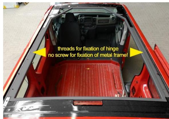
13. Achtung: in drittes Schraubloch von hinten jetzt noch keine Schraube! Wird für Scherenverschraubung
