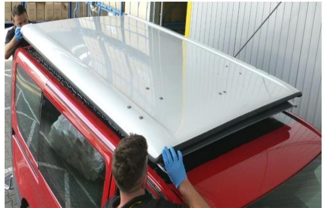
21. Auflegen des vormontierten Easyfit-Rahmens mit Dach.
