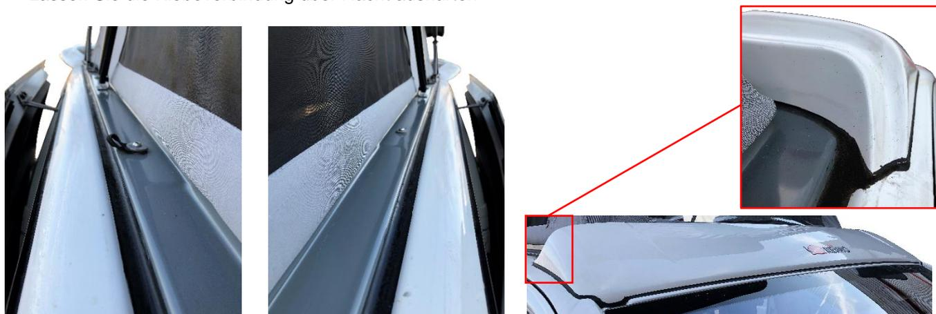
Abb. 7-1: Verfugung des EasyFit-Rahmens und des Frontspoilers
