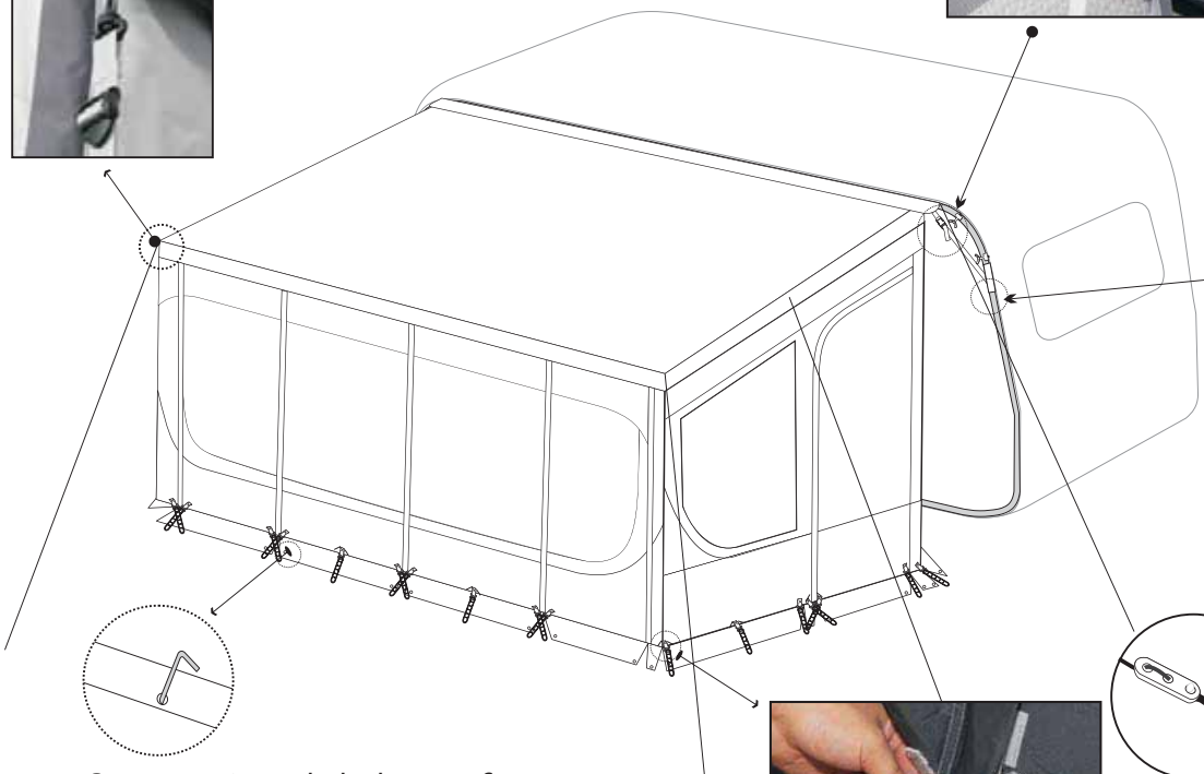
Peg out starting at the back corners first Beginnen Sie die Abspannung am hinteren Ende zum Wohnwagen
