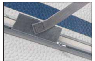
Fix awning bag with awning beading stoppers Feststellen der Markisentaschew mit Stoppfern
