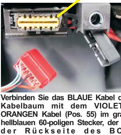
Entfernen Sie die Plastikabdeckung vom schwarzen 16-poligen Diagnosestecker (OBD), unter dem BCM, und verbinden Sie den ROTEN Stecker des Kabelbaums.
