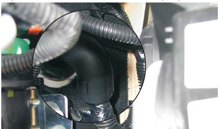
Enlever les 3 vis qui retiennent le cache plastique sous le volant et le démonter.
