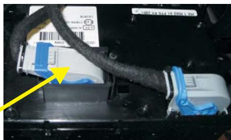
Brancher le fil BLEU du faisceau au fil VIOLET-ORANGE (Pos. 55) du connecteur Gris-Bleu Clair à 60 voies au dos du BCM.
