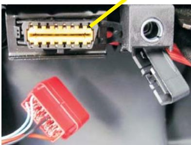
Rimuovere la copertura plastica dal connettore diagnosi (OBD) Nero a 16 vie fissato sotto la BCM e collegarvi il connettore ROSSO del cablaggio.
