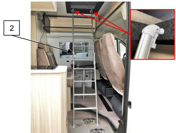
Abb. 9-1: Montage der Leiter im Fahrzeug
