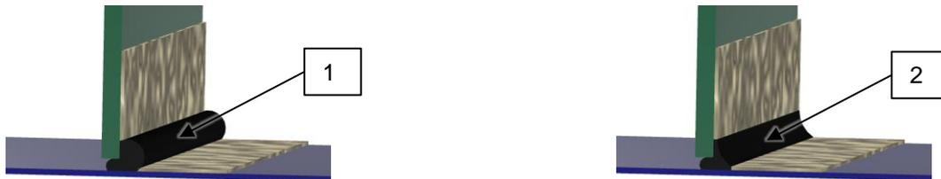
Abb. 6-2: Klebstoffauftrag und Dichtnaht [G0001642]
