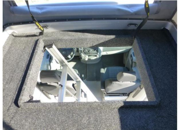
Abb. 8-1: Verkleidung des Dachdurchstiegs
