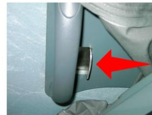
Abb. 2-1: Entriegelung des Schlafdaches
