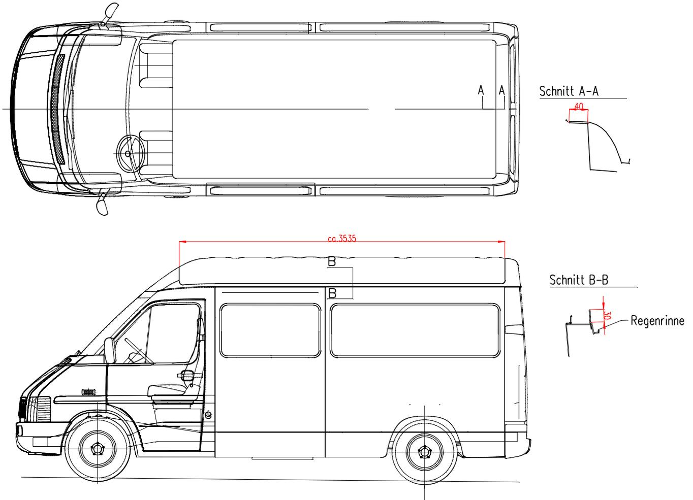
An den Ecken jeweils eine Bohrung 10mm setzen, zum Eintauchen der Stichsäge.
