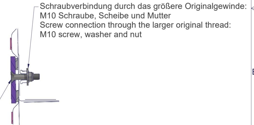
Schrauben mäßig fest anziehen: die adapterplatte muss parallel zum Fahrzeugboden sein, ohne ihn zu verziehen
