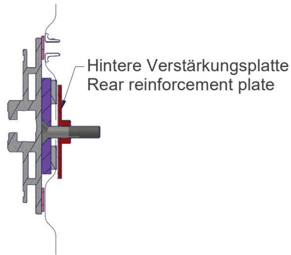
Verschraubung M8: die Schiene muss parallel zum Fahrzeugboden sein, ohne ihn zu verziehen
