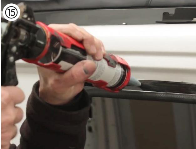
**DE:** **Kleber auf das Fahrzeug auftragen:** Tragen Sie mit der mitgelieferten Düse einen kontinuierlichen, dreieckigen Klebstoffstrahl (Set 294842) entlang der Oberkante des Kantenprofils auf. Tragen Sie den Klebstoff so nah wie möglich am Kantenprofil auf, so dass er unter dem Glas nicht sichtbar ist.
