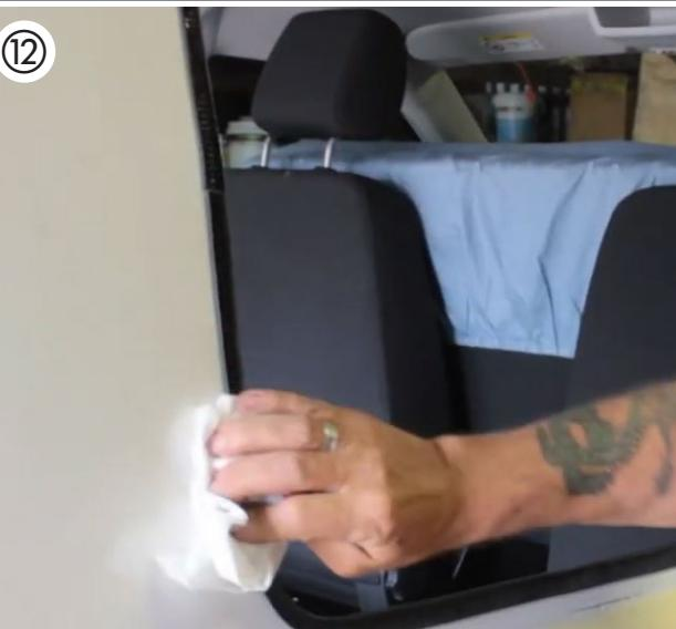
**DE:** **Reinigen der Metalloberfläche:** Verwenden Sie ein Entfettungsmittel und reinigen Sie die Lackierung rund um den Ausschnitt vorsichtig und gründlich. Es ist wichtig, alle Schmutz- und Poliermittelreste zu entfernen, um eine gute Haftung zu erreichen.
