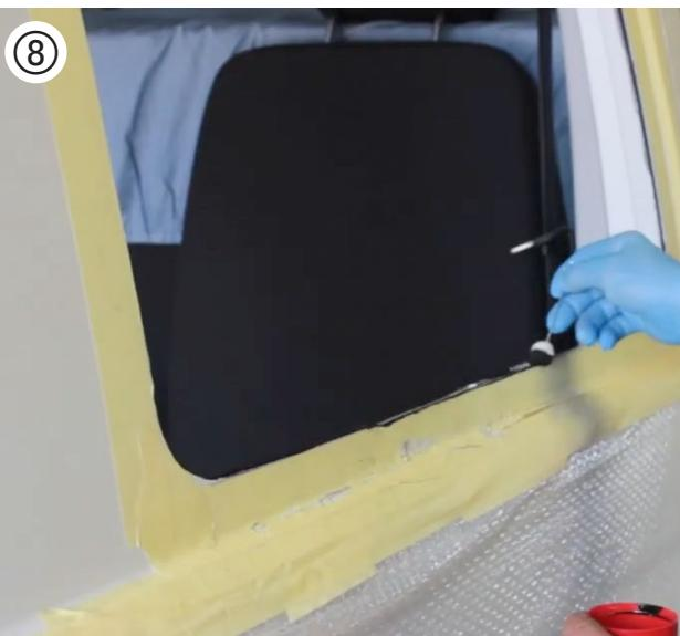
**DE: Freigelegtes Metall grundieren:** Korrosionsschutzbehandlung der Schnittkante der Fensteröffnung mit einem geeigneten Rostschutzmittel (Primer 507 im Set 294842). Abluftzeit: 10 min.
