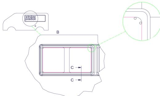
**DE:** **Bohren der Führungslöcher:** Verwenden Sie einen Metallbohrer 10 mm. Bohren Sie von der Innenseite des Fahrzeugs aus zwei Löcher in jede Ecke der Fensteröffnung innerhalb des einwandigen Bereichs, in welche die Stichsäge eingeführt werden soll. Es können bei Bedarf auch mehr Löcher gebohrt werden.
