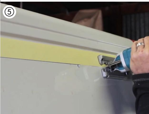
**ES:** **Recorte el panel:** Recorte la línea de corte entre los dos orificios de las esquinas para que el panel permanezca fijo en las esquinas mientras recorta los otros lados. Por último, recorta las esquinas colocando el elevador de ventosa para que el panel no se caiga y dañe el vehículo.
