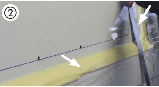
**DE:** **Vorbereitung des Fahrzeugs:** Verwenden Sie breites Klebeband, um die Karosserie (innen und außen) rund um den Schnittbereich zu schützen. Sie können eine dünne Abdeckplane unter der Scheibe verwenden, um die Oberfläche des Fahrzeugs zu schützen und Metallspäne aufzufangen.
