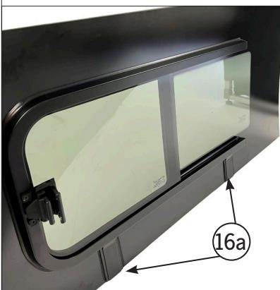
**DE: Verklebung des Fensters am Fahrzeug:** Heben Sie die Scheibe mit den beiden Saughebern an und drücken Sie sie fest gegen das Fahrzeug. Sie können die Scheibe noch ein wenig verschieben, um sie in die richtige Position zu bringen. Wenn Sie sicher sind, dass die Scheibe richtig sitzt, kleben Sie das Klebeband fest, damit die Scheibe nicht verrutscht. Drücken Sie nun vorsichtig um den gesamten Umfang des Fensters herum, damit sich der Kleber verteilen kann und die Scheibe sitzt.
