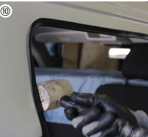
**DE:** **Kantenschutz:** Das Kantenprofil an einem Ende mit einem Schraubendreher leicht öffnen. Von der Mitte der unteren Kante ausgehend, das Kantenprofil rundrum auf die Schnittkante drücken.
