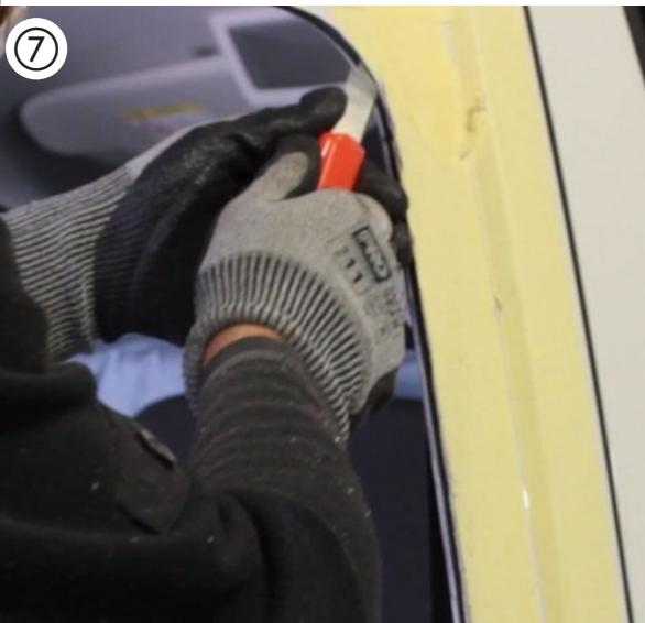
**FR: Recommandation :** retirez l'excédent de caoutchouc pour faciliter le montage du protège-arête. À l'aide d'un long cutter, découpez 2 à 3 cm de caoutchouc tenace entre les deux peaux métalliques sur tout le pourtour de l'ouverture de la fenêtre.
