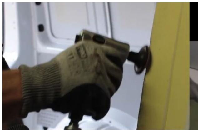
**DE: Kantenbrechen:** Entfernen Sie mit einer Feile oder einer Schleifmaschine den Grat und unsaubere Kanten bis zur Markierung, sodass beide Kanten auf einer Ebene sind. Folgen Sie dabei der inneren Kantenlinie.
