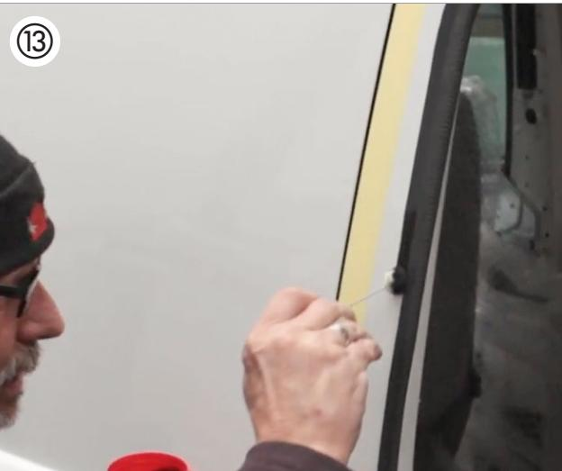
**DE: Grundieren der Metalloberfläche:** Tragen Sie mit einem sauberen Filzapplikator einen Streifen Primer 507 (im Set 294842) um den gesamten Umfang der Aussparung herum auf. Es ist besser, dies in einer durchgehenden Bewegung zu tun, damit sich keine Schichten bilden. Lassen Sie den Primer 10 Minuten abflüften/trocknen.
