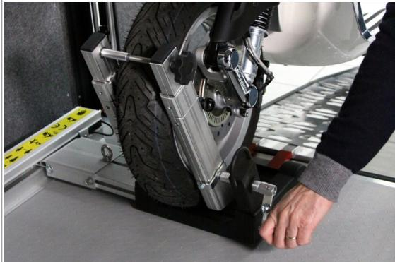
● Mantenere frenato lo scooter con la mano destra e bloccare la ruota avvitando la manovella del morsetto inferiore
