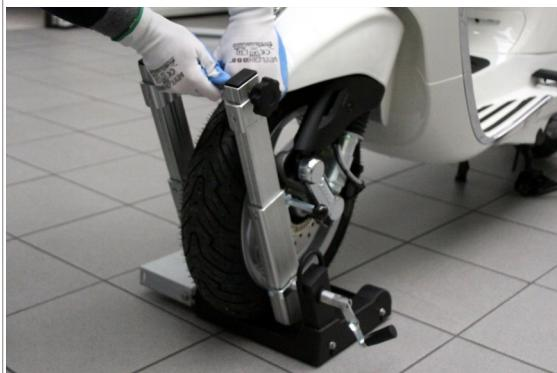
Alzare la ruota dello scooter / moto e posizionare la PINZA sotto lo pneumatico
