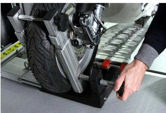
Mantenere frenato lo scooter con la mano destra e bloccare la ruota avvitando la manopola del morsetto inferiore
