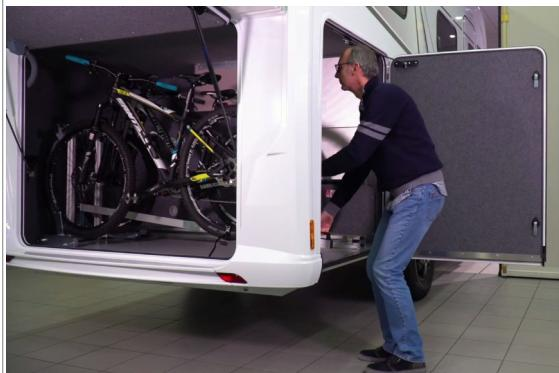
Spingere la slitta fino ad avvertire il bloccaggio della staffa sul finecorsa
