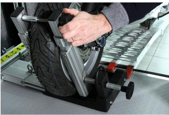
Bloccare la ruota avvitando la manopola del morsetto superiore
