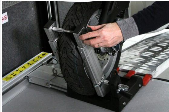
● Bloccare la ruota avvitando il morsetto superiore
