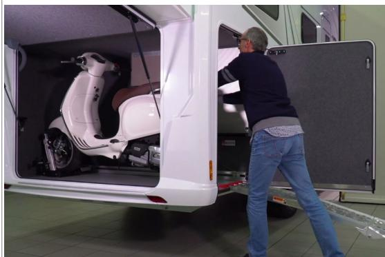
● Spingere fino ad avvertire il bloccaggio della pinza sul finecorsa
