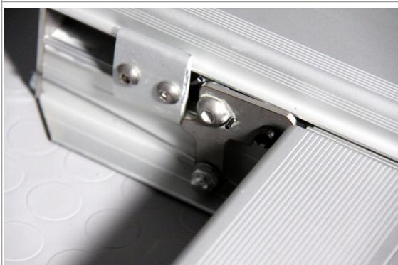
Pinza correttamente bloccata sul finecorsa
