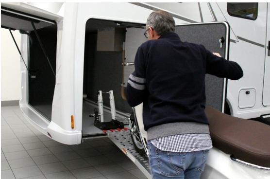
Spingere lo scooter sulla rampa fino ad inserire la ruota nella pinza
