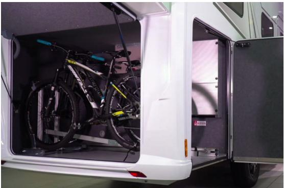
A carico completato, controllare che le ruote anteriori non tocchino la parete del camper
