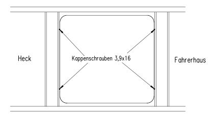
Bohrungen entgraten, Bohrspäne sorgfältigst entfernen und die Bohrungen mit Korrosionsschutz behandeln. Verschrauben des Einbaurahmens: Die Holzecken Ø 3 mm vorbohren und verschrauben.
