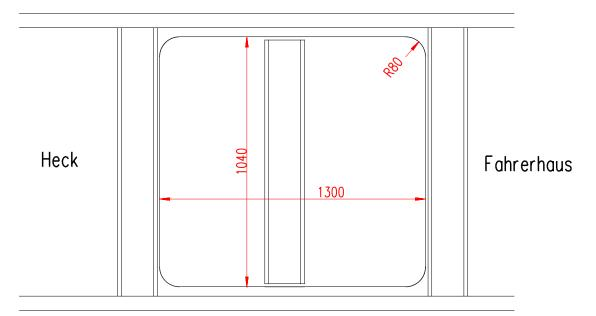
Nach Zeichnung die Maße auf dem Fahrzeugdach anzeichnen <u>und nochmals überprüfen.</u> Eine Bohrung 10 mm setzen, zum Eintauchen der Stichsäge.
