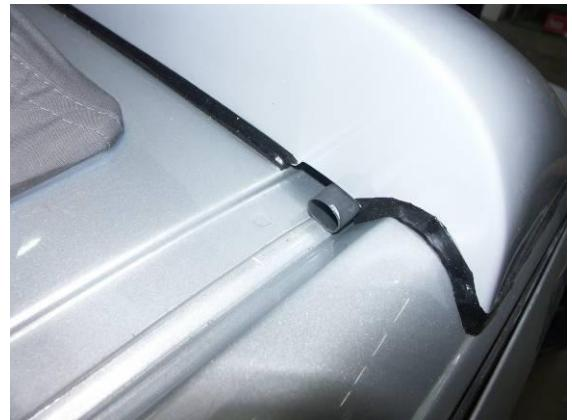
Der Schlauch wird schräg angeschnitten. Diese Seite kommt unter die Windschutzscheibe. Den Schlauch wie dargestellt einführen und anschließend mit Sikaflex den Bereich außen beidseitig abkleben.
