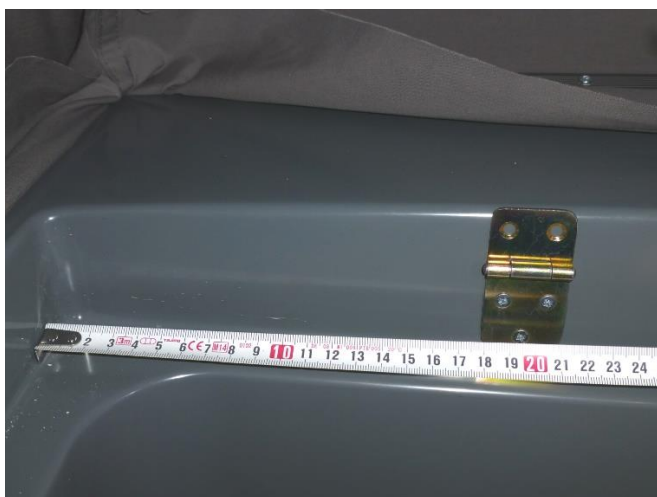
35. Scharniere an der Rückseite des GFK-Rahmens montieren Mount hinges on the rear of the GRP-frame
