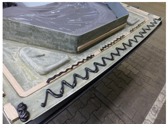
18. Nach Reinigung: Sikaflex® 522 Auftrag auf GFK-Rahmen vorne After cleaning: application of Sikaflex® 522 on GRP-frame front area
