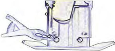
Schritt 1: ENTFERNEN SIE DIE SPLINTE UND ZIEHEN SIE BOLZEN HERAUS.
