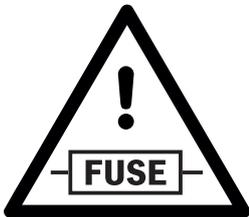
**Cuando se conecte a la batería, asegúrese de utilizar el fusible suministrado para evitar daños en el vehículo y en los enchufes. Inserte el fusible en el cable + 12V / rojo.**
