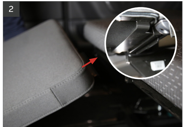
2 Rückenlehnen abklappen und Bettverlängerung unterhalb der Sitzkante in den dafür vorgesehenen Bügel einhängen.
