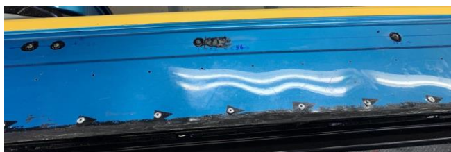
Bild 3: Verstärkungsrahmen genietet und verklebt (Bild ABH)
