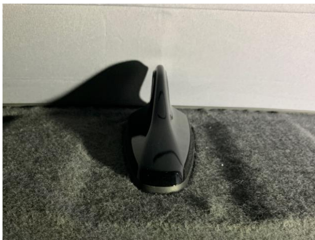
Bild 7: Dachantenne innen im Aufstelldach (Bild ABH)
