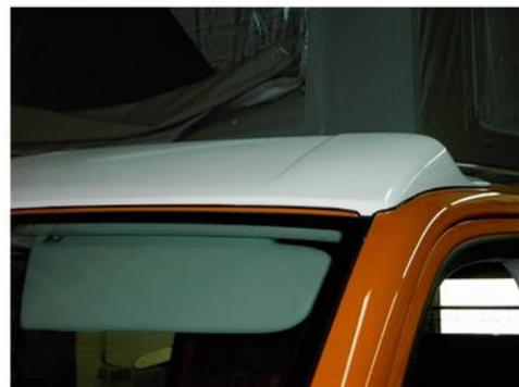
Abb. 4-1: Montage des Frontspoilers
