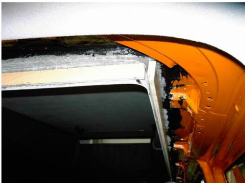
Abb. 3-3: Verklebung des Schlafdaches
