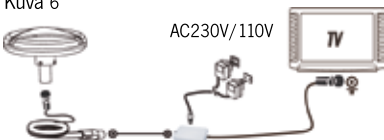
Asennus 1: Asennus suoraan televisioon (Kuva 6)
