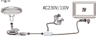
Installation 1: Connection directe à la télé (Fig. 6)
