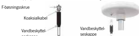
(Fig. 5) Stik koaksialkablets "F"-stik ind i antennen "F"-bøsning og fastgør den vandtætte kappe på enden af den tilsluttede "F"-tilslutning.
