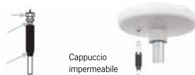
(Fig. 5) Inserire la spina „F“ del cavo coassiale con la presa „F“ dell'antenna e collegare il cappuccio impermeabile alla fine del collegamento connettore „F“.
