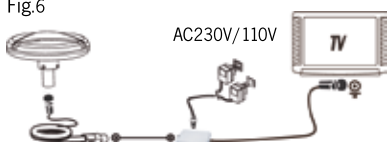
Installation 1: Forbindes direkte til fjernsynet (fig. 6)
