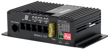
MPPT-Doppel-Solarladeregler 12 V/12 A, max. 165 W (851005)
