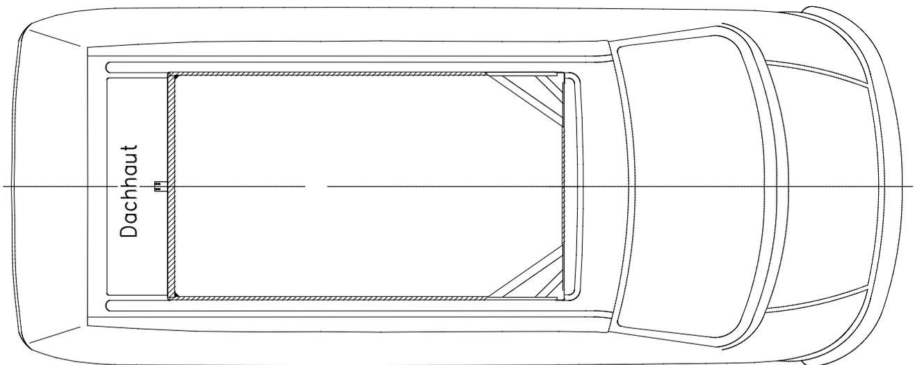
Einbaurahmen mit 4 Schrauben M6x20 durch die Laschen verschraubt und zusätzlich ca. alle 300mm vernietet, sowie mit Sikaflex verklebt!
