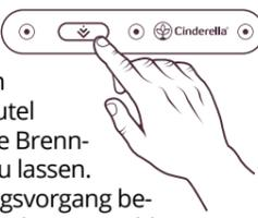
Drücken Sie die „Start“-Taste, um den Toilettenbeutel samt Inhalt in die Brennkammer fallen zu lassen. Der Verbrennungsvorgang beginnt, sobald die Klappe geschlossen ist. Die Toilette ist nun bereit für die nächste Benutzung.
