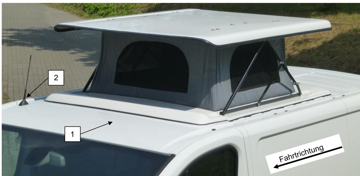
Abb. 5-1: Äußere Dichtnaht
