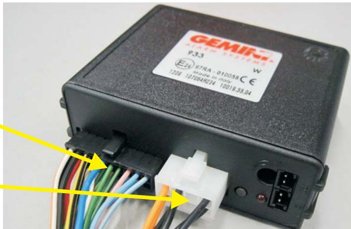
Inserire i connettori del cablaggio nel corrispondenti connettori della centralina.
