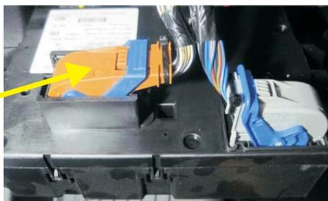
**CONNEXION SUPPLÉMENTAIRE** pour véhicules avec **VERROUILLAGE CENTRALISÉ DE LA PORTE CELLULE** ou avec **TÉLÉCOMMANDE D'ORIGINE À 3 BOUTONS**
