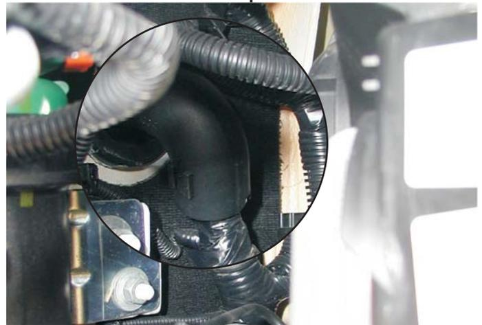
Schieben Sie den Verriegelungshaken, der das BCM-Steuergerät sichert, nach rechts.
