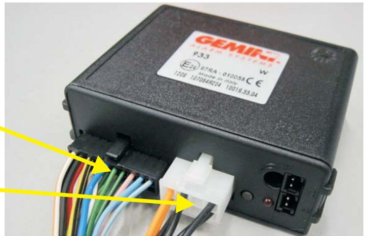
Stecken Sie die Kabelbaum Stecker in die entsprechende Buchse am Alarmsteuereinheit.
