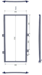
Bild 8: Dachrahmen aus 30x30x2 Stahlrohr
