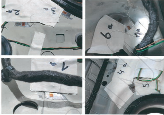
Abbildung A1.2 – DMS-Applikation DMS 1 - 7
