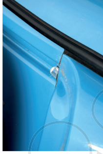
Bild 10: Wasserablaufschlauch in der Dachrinne vorn
