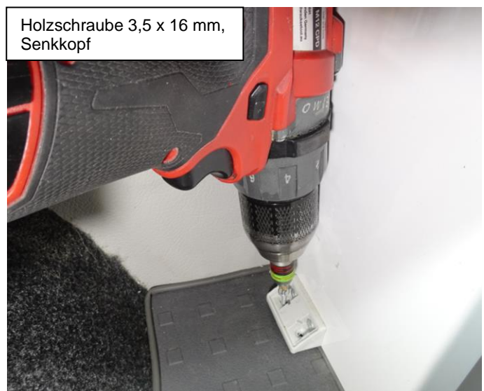
Verschraubung des Korpus in den Radkasten
