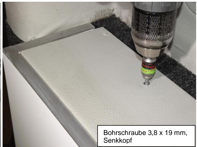
Verschraubung des Korpus in den Radkasten
