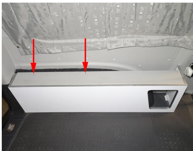
Korpus in korrekter Position, Schraubpositionen
