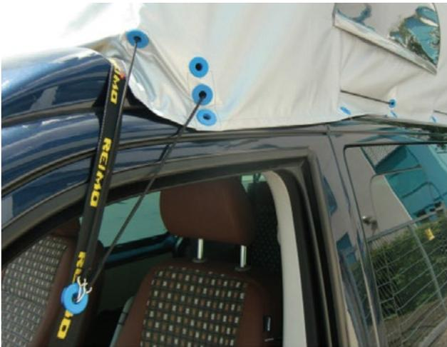
Bei Bedarf kann durch die vorderste Öse die innen liegende Gummileine in der vorderen Ecke gezogen und in die Öse an den vorderen Gurten eingehängt werden.
